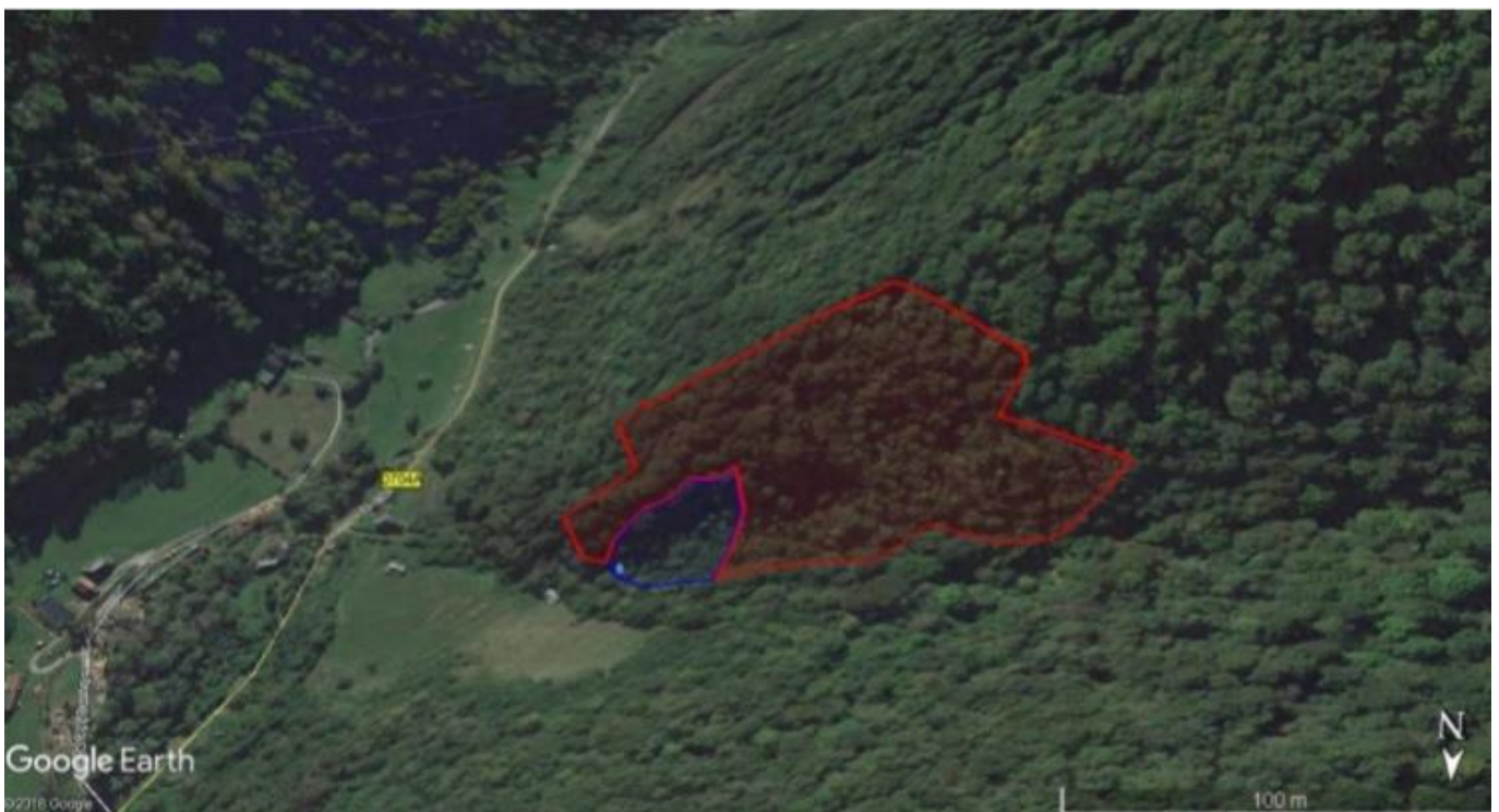
Illustration 38 : Périmètre de Protection Immédiate (en bleu) et Périmètre de Protection Rapprochée (en rouge) du captage de « Coume Arrau Biac Rive G » sur photographie aérienne (Fond de plan : Google Earth / Source : J.M. Gandolfi, 2019, Avis de l'hydrogéologue agréé en matière d'hygiène publique)
